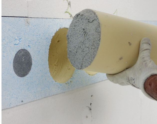
Assurance qualité pour vérifier le collage parfait grâce à un carottage.
